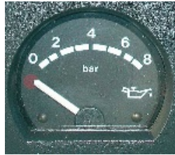
Manometro dell'olio (impianto di lubrificazione)
